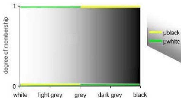
Figure 1. Fonctions d'appartenance (fonctions caractéristiques) en théorie des ensembles classiques (adaptation de: Havinga, 1999)
